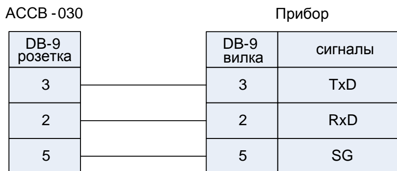
Рис.3. Подключение прибора по интерфейсу RS-232.
